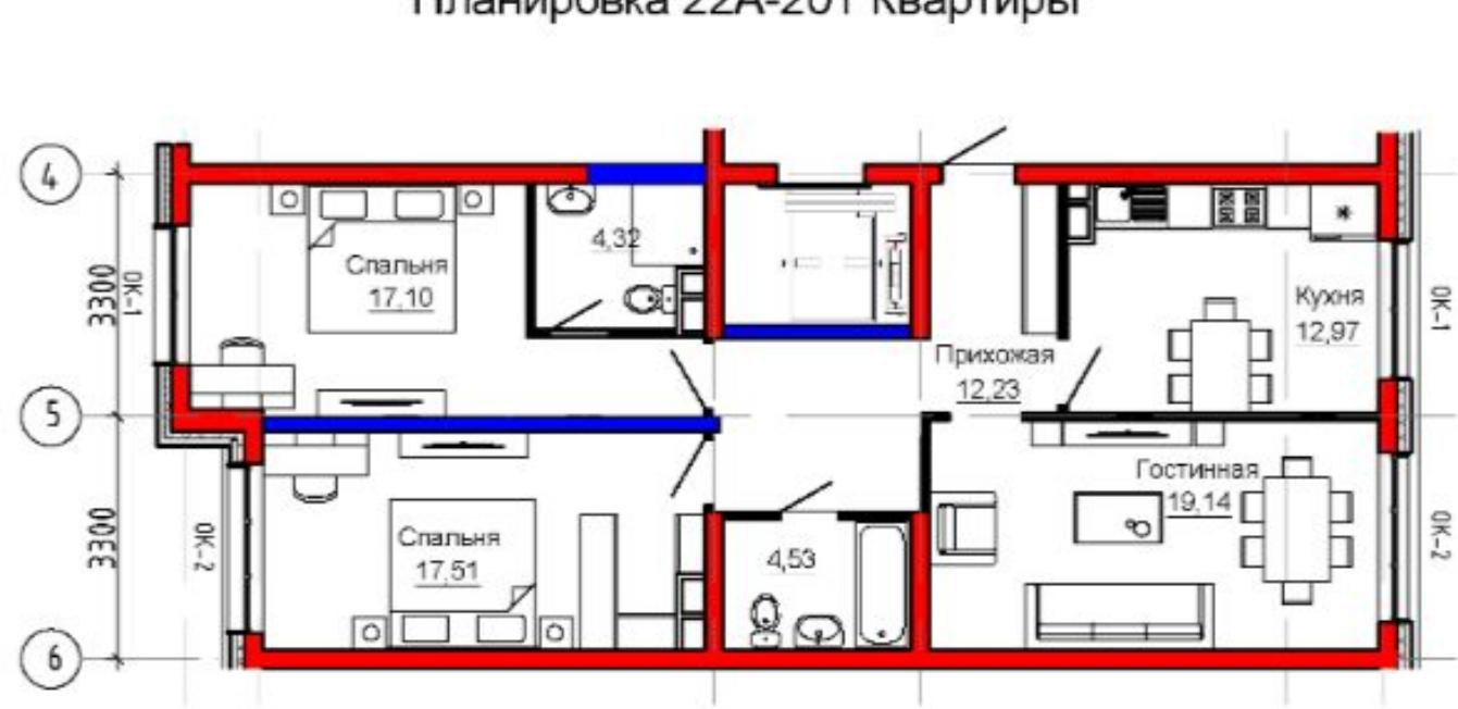
Стены из Бетона
